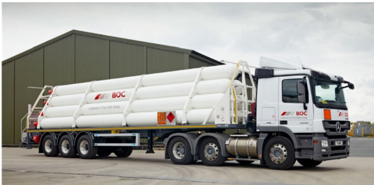
Een tube-trailer met 9 stalen drukcilinders ( 200 bar ) (M-Tech, 2020)
